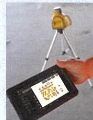
CADを使った墨出 システムの実演
